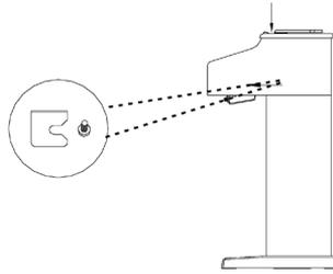
Поднимите с помощью другого человека корпус фортепиано на стойку и продвиньте его вперед, чтобы расположенные внизу направляющие стержни вошли в прорези боковин (см. рис.).
