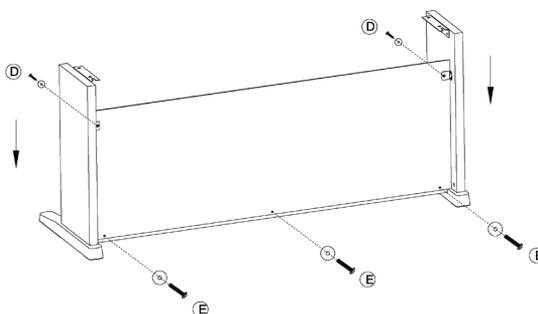
С помощью двух болтов тыльной панели (D) с шайбами и трех болтов тыльной панели (E) с шайбами прикрепите тыльную панель к стойке. Обратите внимание, соответствующих отверстий в блоке педалей не просверлено. Это необходимо сделать самостоятельно.
