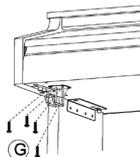
Прикрепите держатель для наушников. Для этого прикрутите его к нижней панели корпуса фортепиано с помощью четырех болтов (G).
